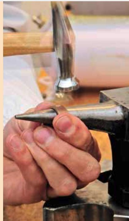
Anschließend wird er durch Hammerschläge geglättet und in Form gebracht.
